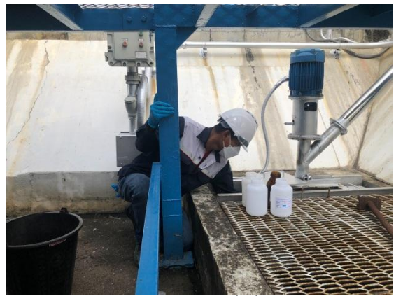
รูปที่ 3.2.1-6 วิธีการเก็บตัวอย่างน้ำทิ้งจากบ่อพักทศเหนือ
