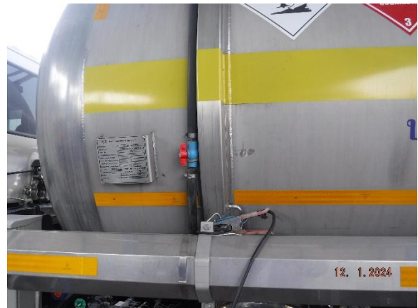
รูปที่ 2.2.2-3 จุดต่อสายกราวด์ตัวรถ Bulk
