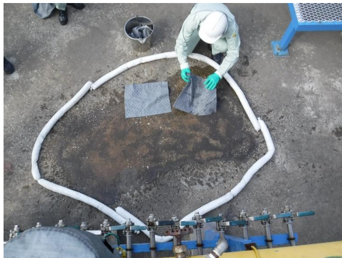
รูปที่ 2.2.3-1 การเก็บกวาดสารเคมีที่ไหลนองพื้นด้วยภาชนะที่ไม่ก่อประกายไฟลงถัง
