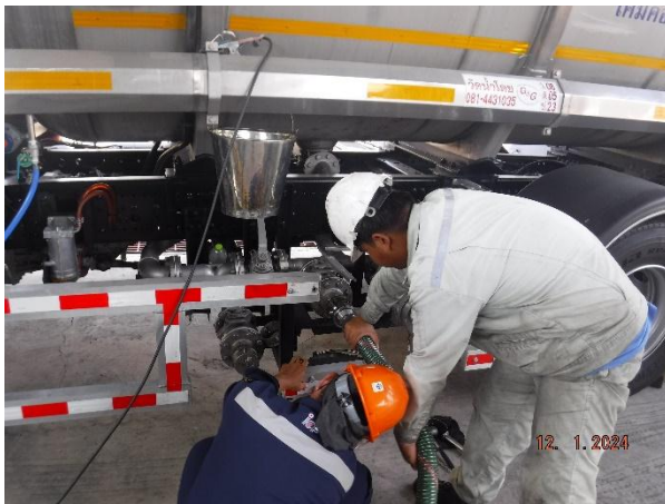
รูปที่ 2.2.2-2 การตรวจสอบระบบท่อจ่าย
